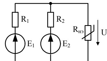
13. В цепи постоянного тока, изображенной на рисунке,  $R_1 = R_2 = 6 \Omega$ ,  $E = 12 \text{ В}$ . Симметричная ВАХ нелинейного элемента задана в виде таблицы. Определите напряжение на НЭ  $U$ .
