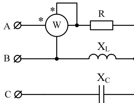
Определите показание ваттметра.
